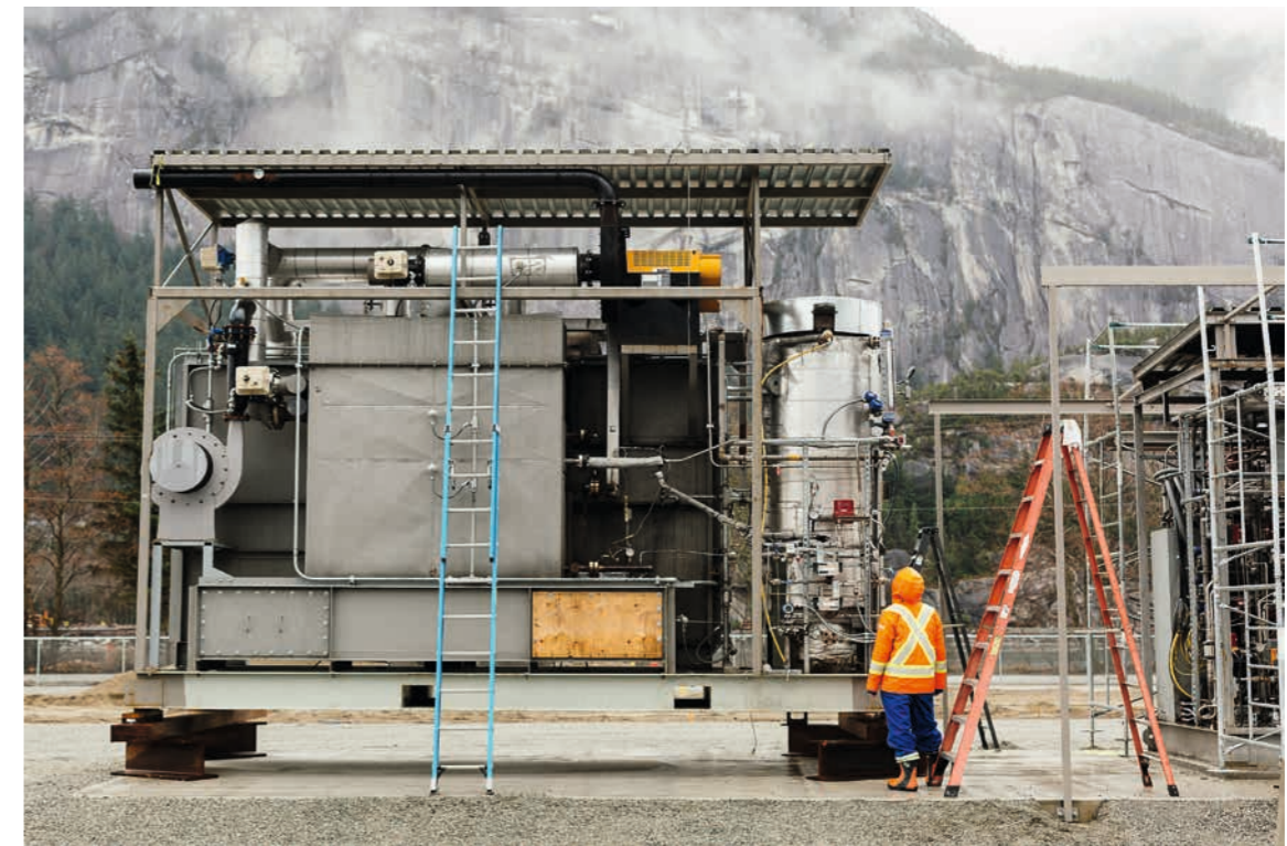
8.10 > Diese Anlage scheidet Kohlendioxid aus der Umgebungsluft ab und stellt daraus einen Treibstoff her. Sie wurde vom kanadischen Unternehmen Carbon Engineering entwickelt, welches auch am Bau erster großer DAC-Anlagen in den USA beteiligt ist.
